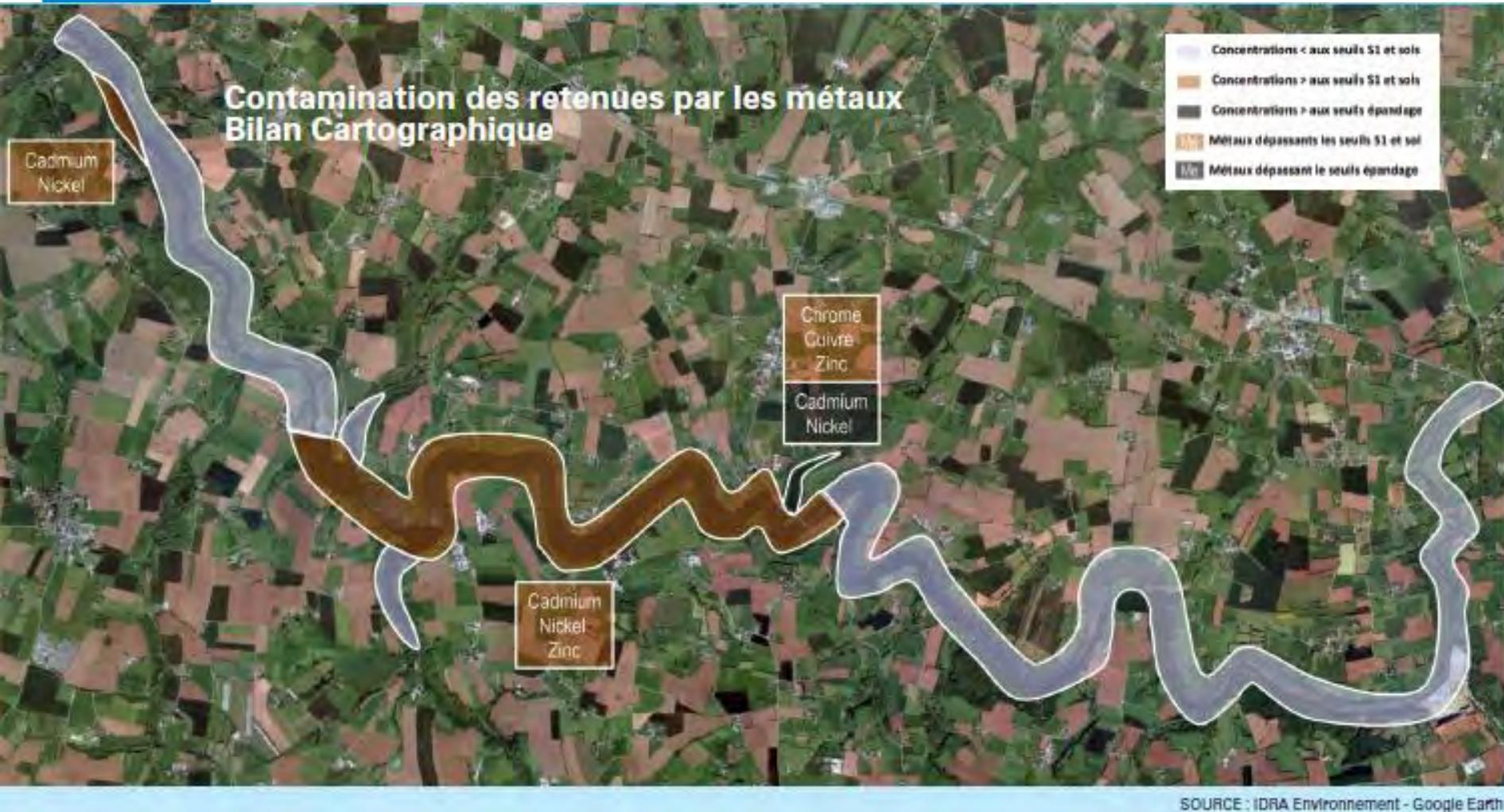
Contamination de l'aval de Vezins à partir de l'Yvrande, dépassement des seuils S1 sur Ni, Cd et Zn
